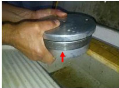
Après avoir lavé et rincé la vanne, la souffler avec de l'air comprimé.
