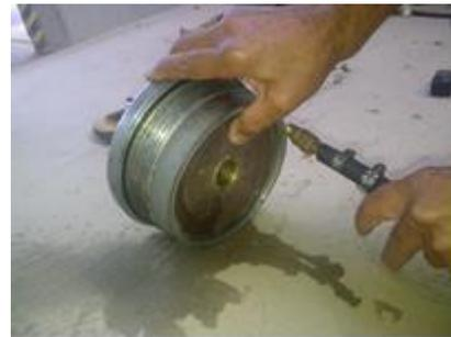
Après avoir effectué les inspections ci-dessus, réassembler la vanne dans le récipient et tester l'efficacité (remplissage et déclenchement).
