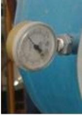
La vérification de l'efficacité lors du déclenchement du canon est mesurée par une évacuation instantanée de la cuve, c'est-à-dire que la valeur de pression mesurée sur le manomètre devrait chuter instantanément à zéro ou presque à zéro après le déclenchement. Toute observation autre que celle-ci caractérise une défaillance de fonctionnement. **Le manomètre doit toujours**
